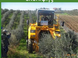
Μηχανική συγκομιδή ελιάς Με τη ελαιοσυλλεκτική Gregoire G120 (Ιδιοκτησία Φυτώρια Αναστασόπουλος - συνεργατών του Κέντρου Ελιάς KRINOS)
